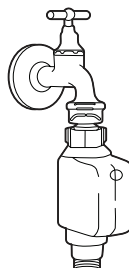
Tuyau de sécurité
